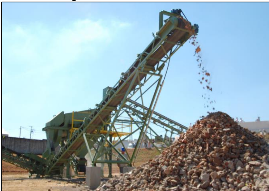
Figura 90 - Usina fixa de RCC.
