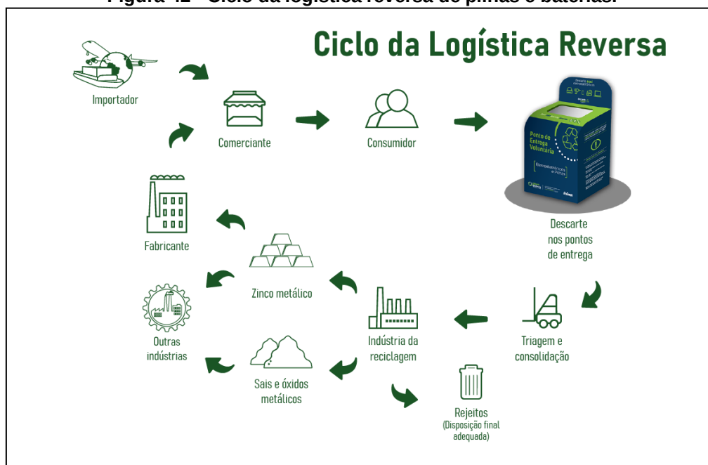
Figura 42 - Ciclo da logística reversa de pilhas e baterias.
