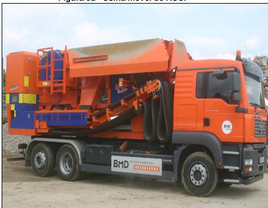
Figura 91 - Usina móvel de RCC.
