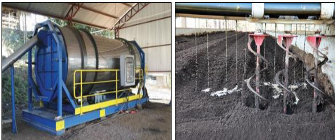
Figura 86 - Reator de compostagem acelerada e compostagem mecânica de dejetos de suínos.
