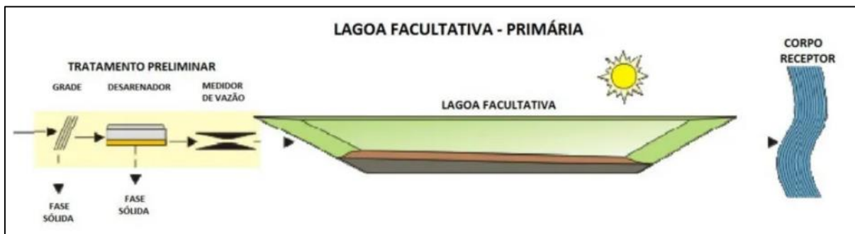
Figura 25 - Representação do Sistema de Tratamento de Esgoto.
