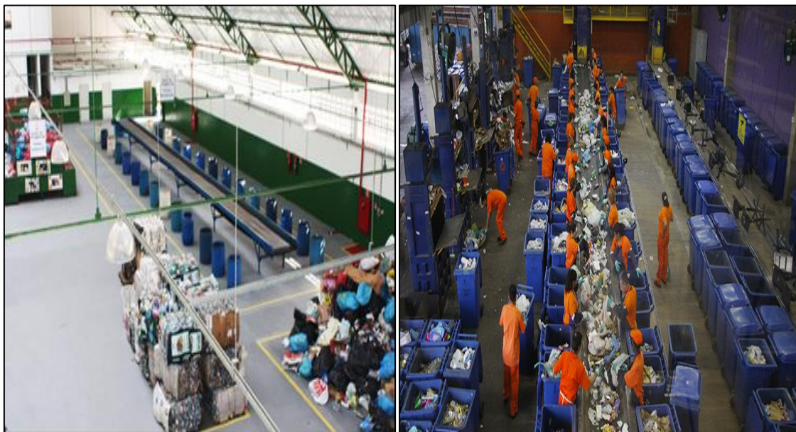
Figura 83 - Centro de Triagem de Resíduos Sólidos - CTRS e segregação de resíduos recicláveis e não recicláveis.
